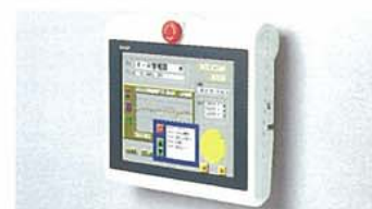
壁固定方式 注: 本体背面の固定用ナットはM4深さ4mmです。適合したビスをご使用ください。締め付けトルクは約1.6N・m
