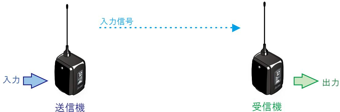
送信機のCH 1～CH 5の入力に対応して、受信機のCH 1～CH 5を出力します。
