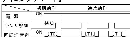
\*T0: 初期センサ起動(初期電源投入時よりセンサ動作スタンバイするまでの間)[T0]は、回転灯と音声が作動し続けます。
