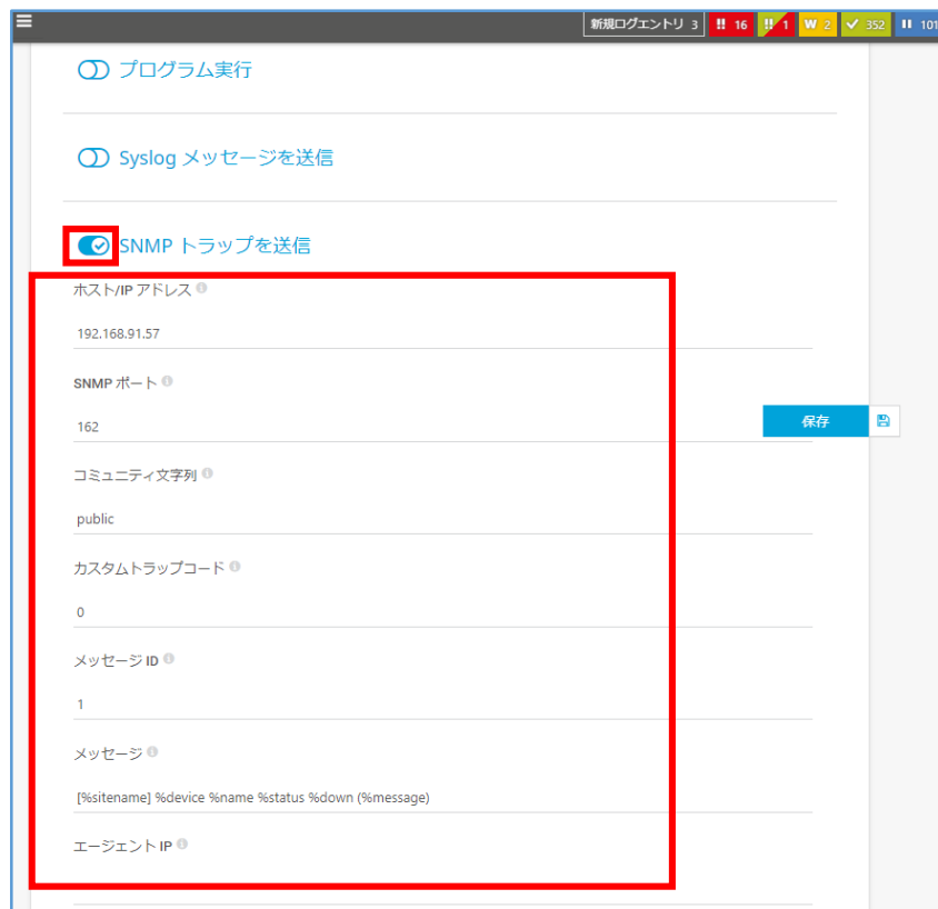
図 18 SNMP トラップを送信する通知テンプレート設定例 下部
