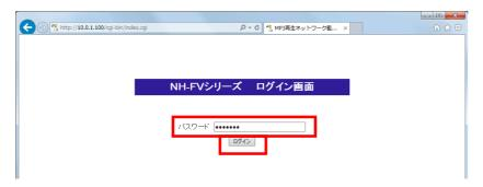
ログイン後、ブラウザの左側にメニューが表示されるので、「セットアップ項目」→「SNMP 設定」をクリックします。
