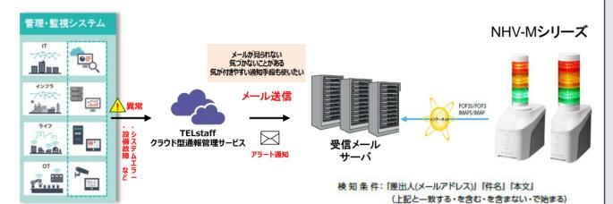
NHV-Mからメールサーバーにアクセスし、検知条件に合致したメールを受信した際にLED点灯・音声によって知らせることができます。NHV-M からメールサーバーヘアクセスするためPCレスで運用ができ、既存システムなどに手を加えることもありません。「パスワード認証」だけでなく
