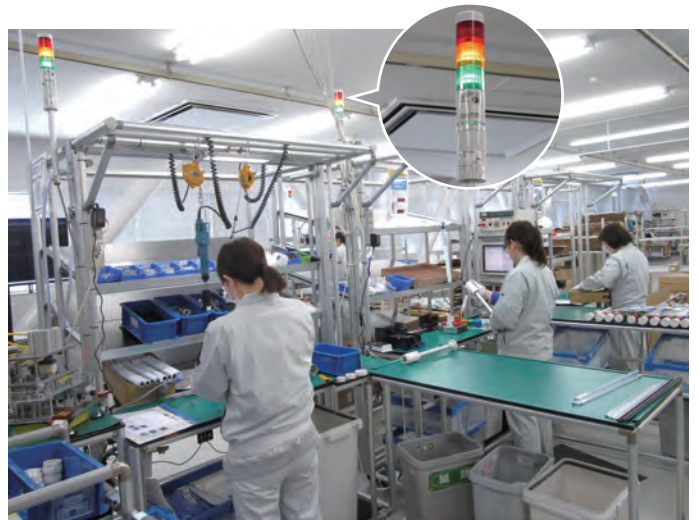
2017年11月から三田工場に導入された「AirGRID® WD」。主力生産ラインの稼働管理が開始された。
