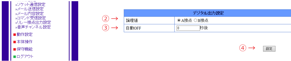
図 4.9.2 リレー接点出力 デジタル出力設定画面
