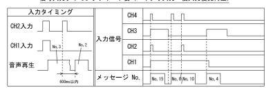
6-5-7. ビット入力・ホールド再生モード (動作モード切替スイッチ: G) CH1~4端子がビット入力に対応し、選択しているCHを保持している間メッセージを再 生します。入力がなくなると再生を停止します。
